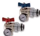
**350TK/1** Coppia di valvole a sfera ad angolo a passaggio integrale con bocchettone ad attacco per collettore con tenuta O-Ring, complete di termometro scala 0 ÷ 80°C. Misura disponibile 1"
