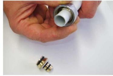
Infilare la calotta completa di anello tagliato premontato nella tubazione da collegare
