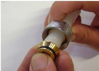
Introdurre fino a battuta il corpo del raccordo nella tubazione esercitando una sufficiente pressione
