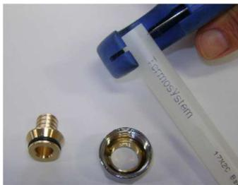
Das Rohr mit einem geeigneten Werkzeug schneiden, um einen schnellen und genauen Schnitt zu erhalten.
