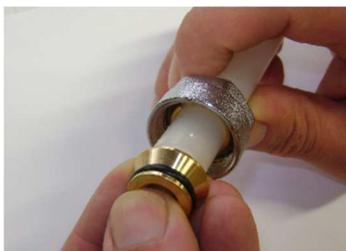
Mit ausreichender Druck, der Verschraubungskörper ins Rohr einsetzen.
